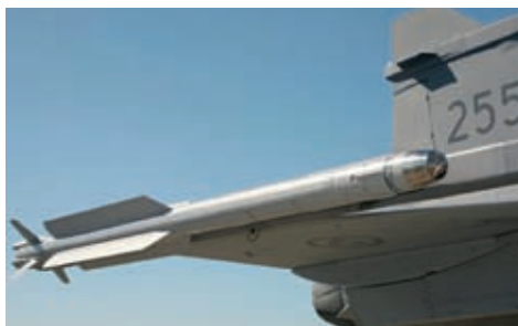
Jaktrobot IRIS-T på JAS 39 Gripens vingspets.
