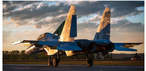
En Su-30 SM startar. Planet har vektoriserade munstycken.
