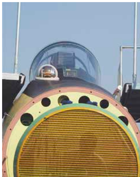
Su-35 S radar av PESA-typ. IRST-kupolen är ovanför.
