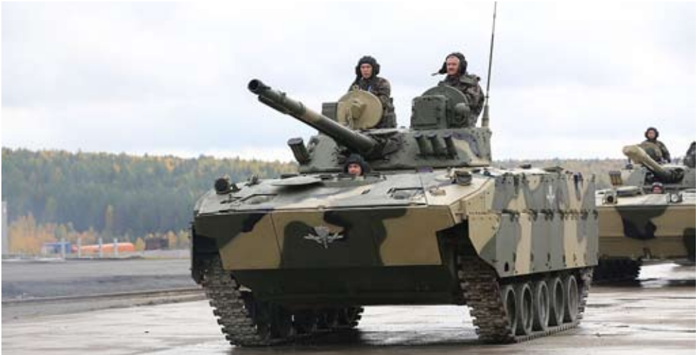
Nya pansarskyttefordonet BMD-4M luftlandsätts med besättningen i fordonet. Vikt 13,5 ton, maxhastighet 70 km/h, beväpning 10 cm kanon med parallellkopplad 30 mm akan.
