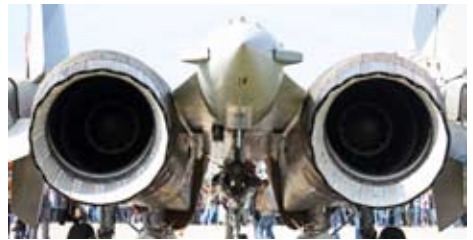
Su-35:s motorer har vektormunstycken vilket medger att jetstrålen kan riktas.
