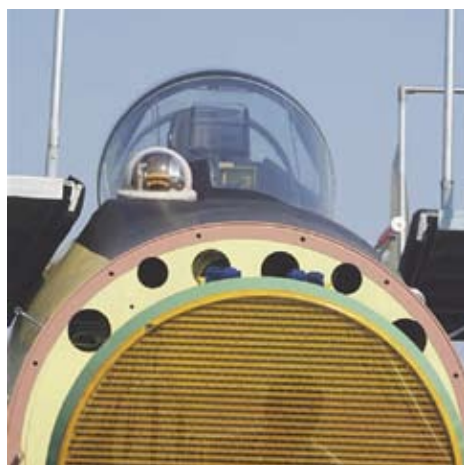
Su-35S med PESA-radar och IRST-kupol vid cockpit.
