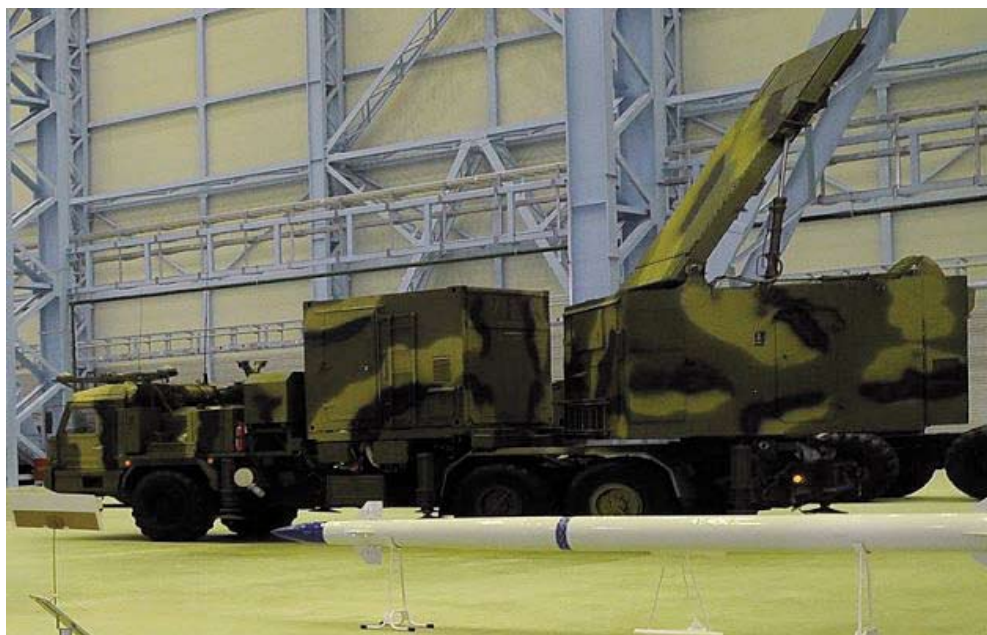
50N6A multifunktionsradar med roboten 9M96 i förgrunden.
