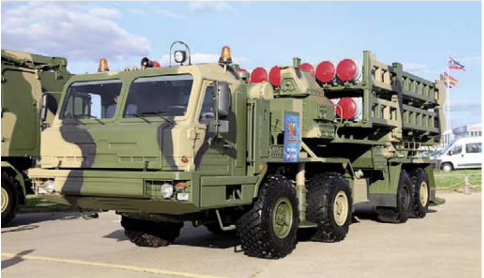
S-350E "Vityaz" robotfordon med sina 12 robotar.
