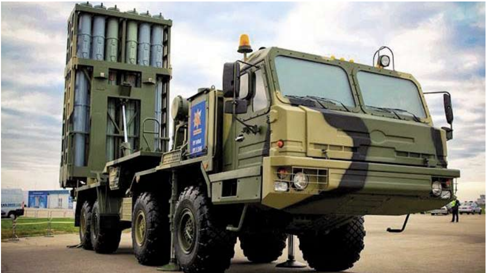
Terrängfordon BAZ med robotenhet i S-350E-systemet. Totalt kan ett batteri S-350E engagera upp till 16 mål samtidigt.
