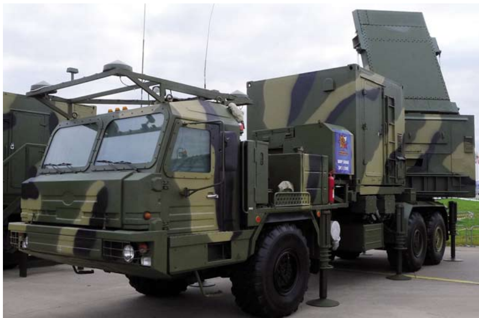
Radarfordon i S-350E-systemet. Dess radar 50N6E kan följa upp till 40 olika mål i en 90° sektor.
