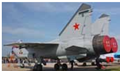
MiG-31BM har en radarräckvidd på upp till 320 km. Startvikten är 46,2 ton, mer än dubbelt så mycket som den tyngsta versionen av MiG-29.
