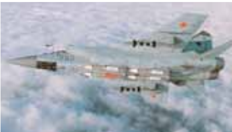
MiG-31 med vapenlast. De senaste MiG-31-versionerna har tio vapenbalkar. Utöver jaktrobotar och signal-sökande robotar kan man nu även ta med styrda attackvapen.
