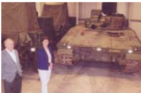
Prototyp av Lvkv 90, vagnen kunde med radar upptäcka helikoptrar bakom trädriddäer och stå i bakhåll med sikte, laser och eldrör inriktade för sekunds snabb bekämpning. Foto Georg Werle
