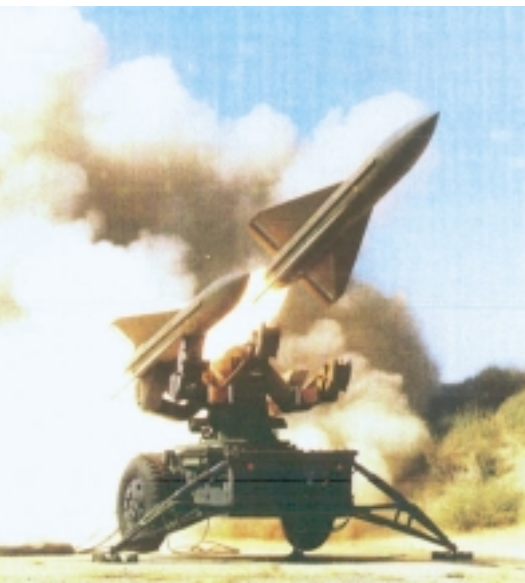
Avfyringsrampen för RBS 97. Hawkroboten i utskjutningsögonblicket. Stora krafter behövs för att den tunga roboten ska accelerera snabbt.
